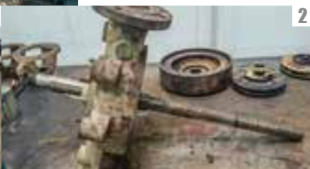
PHASES DE REMONTAGE D'UNE POMPE MULTICELLULAIRE WKL
