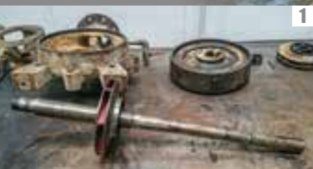
PHASES DE REMONTAGE D'UNE POMPE MULTICELLULAIRE WKL
