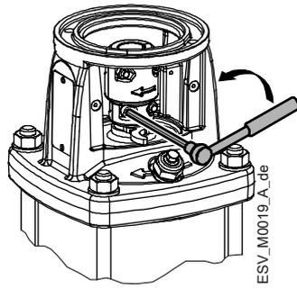
3. Fixer le moteur sur l'adaptateur à l'aide de boulons (non fournis).
