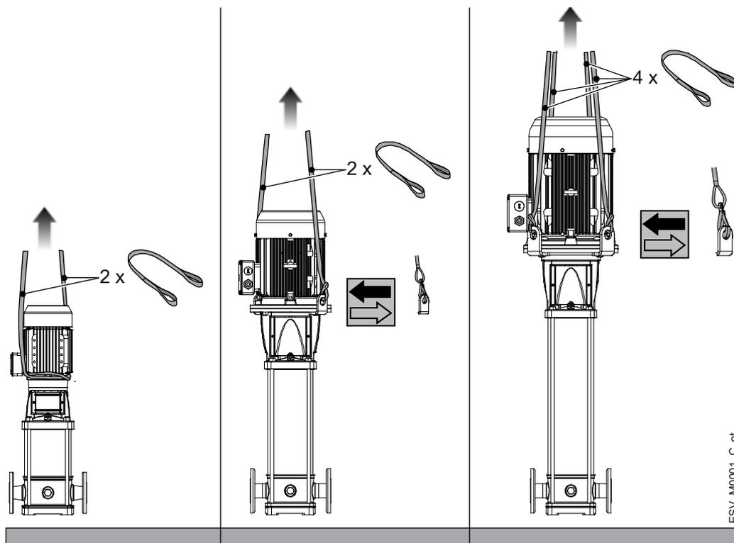
Les pitons à œil doivent être utilisés exclusivement pour soulever l'unité de sa position horizontale et uniquement pour la durée nécessaire. Voir les figures ci-dessous.
