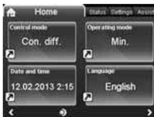
Fig. 17 Exemple d'affichage principal sur une TPE Série 2000 avec panneau de commande avancé
