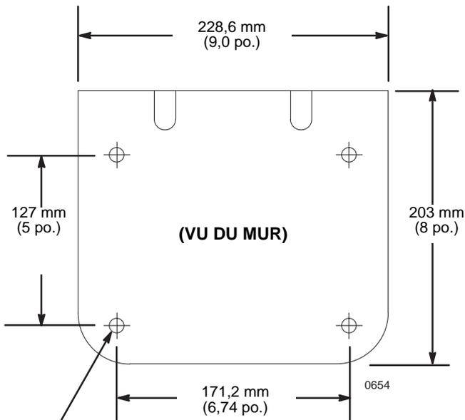
Quatre trous avec un diamètre de 11 mm (0,438 po.)
