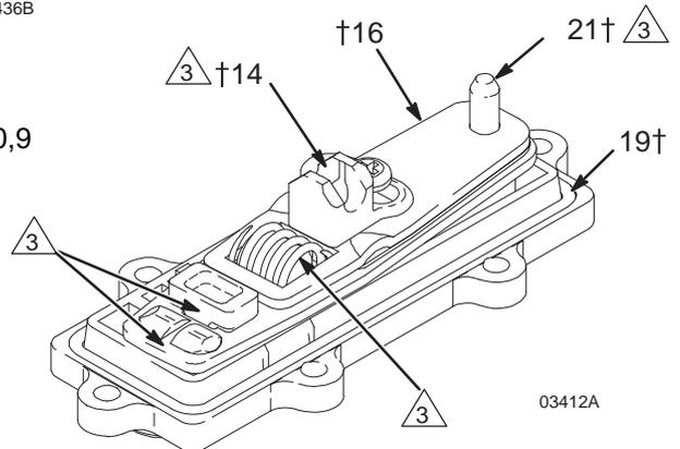
1 Serrez uniformément et en diagonale à un couple de 0,9 à 1,6 N-m (8 à 14 po-lb).
