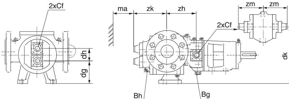
Enveloppe simple (SO) avec raccord fileté sur le couvercle de pompe
