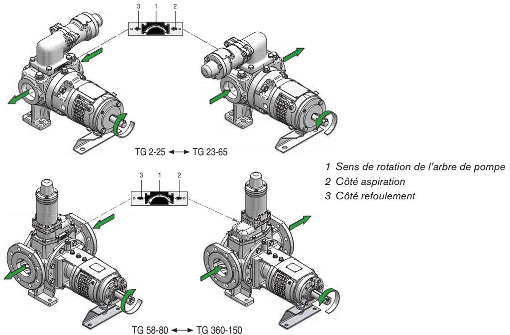
**Nota!** La rotation de l'arbre est toujours considérée depuis l'extrémité de l'arbre vers la pompe. Sauf si la commande le spécifie autrement, les pompes TopGear sont conçues en usine pour une rotation dans le sens des aiguilles d'une montre (figures de gauche en haut), que nous qualifions de sens standard de rotation.
