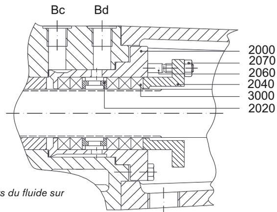
Circuit de raccordements du fluide sur un presse-étoupe
