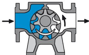
Le liquide est véhiculé dans des alvéoles étanches vers le refoulement.
