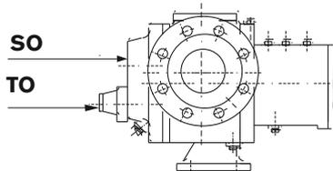
Enveloppe simple (OS) avec raccord fileté autour de l'étanchéité d'arbre
