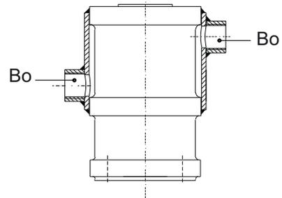
En cas d'approvisionnement en vapeur, reliez la conduite d'alimentation le plus haut possible et la conduite de retour le plus bas possible, de sorte que l'eau condensée soit drainée via la conduite inférieure. En cas d'approvisionnement en liquide, les positions ne sont pas importantes.
