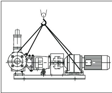
Fixez les élingues de levage autour de l'avant de la pompe et de l'arrière du moteur. Vérifiez que la charge est équilibrée avant de commencer le levage. **NB !** Utilisez toujours deux élingues.
