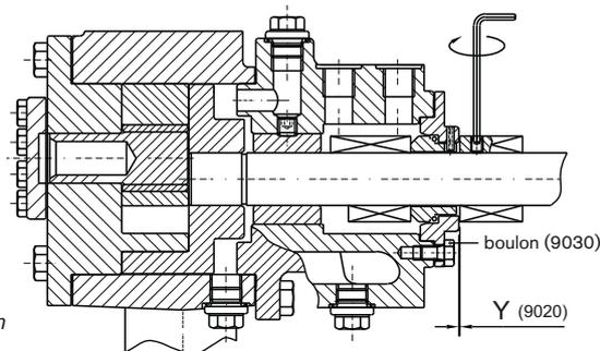
Montage de la garniture mécanique double en tandem (GG)
