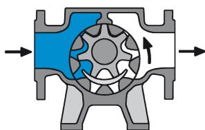
Au fur et à mesure que le rotor et le pignon se désengrènent, une dépression se crée et le liquide pénètre dans les cavités nouvellement créées.
