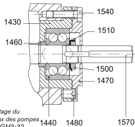
Démontage et montage du roulement à rouleaux des pompes TG GM2-25 et TG GM3-32
