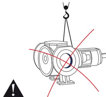
*Ne jamais lever la pompe par deux points d'attache seulement. Un levage incorrect peut provoquer des accidents corporels et/ou endommager la pompe.*
