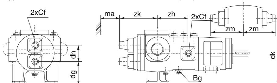
Enveloppe simple (SO) avec raccord fileté sur le couvercle de pompe
