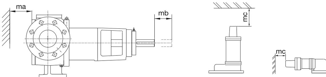
Il est impératif que le dispositif de commande de la pompe soit toujours accessible (y compris en cours de fonctionnement).
