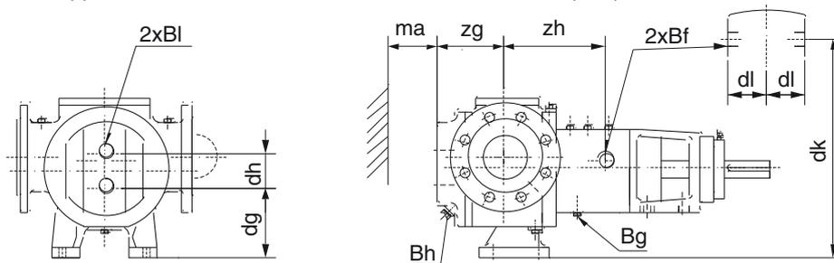
Enveloppes (TT) avec raccords à bride sur le couvercle de la pompe et autour de l'étanchéité d'arbre
