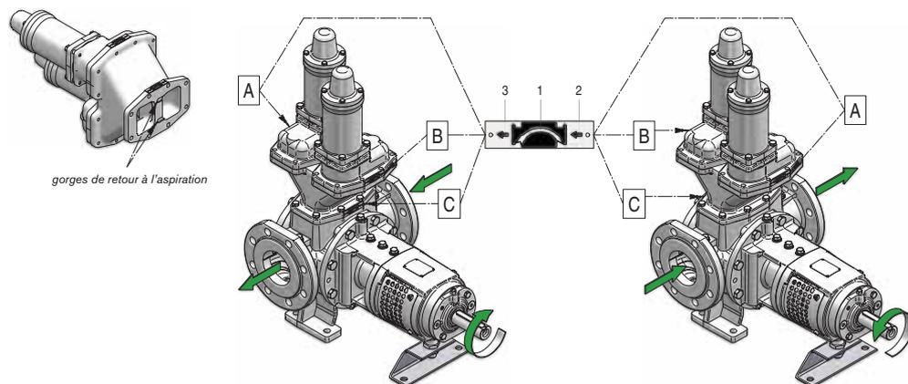
Lorsqu'une soupape de décharge double est installée, trois plaques fléchées sont fixées – une sur chaque soupape (A et B) indiquant le sens d'écoulement du liquide, (petites flèches 2 et 3) et une sur la culotte de la soupape (C) indiquant le sens le plus favorable de rotation de la pompe (flèche 1).
