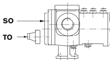
Enveloppe simple (OS) avec raccord fileté autour de l'étanchéité d'arbre
