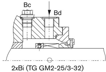
**Barrage sous pression (double étanchéité)**
