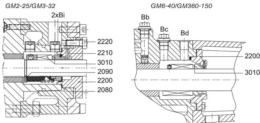
Circuit de raccordement du fluide pour une garniture mécanique simple
