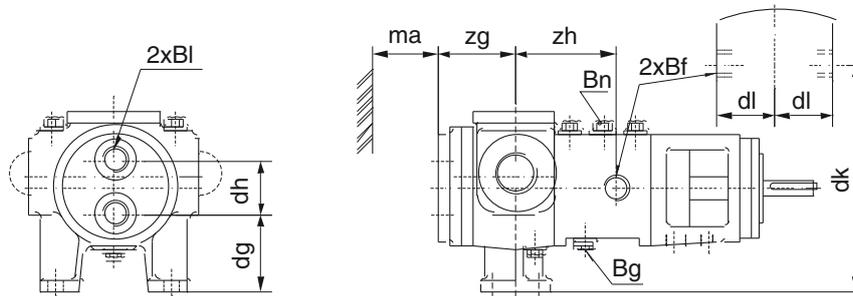
Enveloppes (TT) avec raccords à bride sur le couvercle de la pompe et autour de l'étanchéité d'arbre
