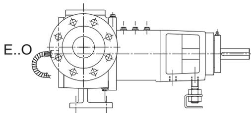
Chauffage électrique autour de l'étanchéité d'arbre (dans le carter intermédiaire) = OE..
