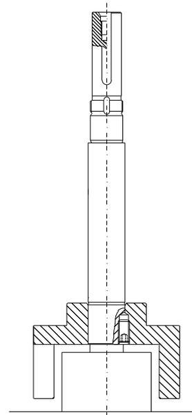
**Nota !** Ajouter une graisse de qualité et de type appropriés. Ne remplissez pas excessivement.
